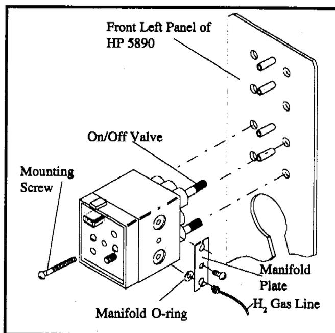
Figure 3.4. Gas Flow Module
