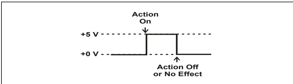
*Figure 12-1. Positive Edge TTL Input Signal Mode*
