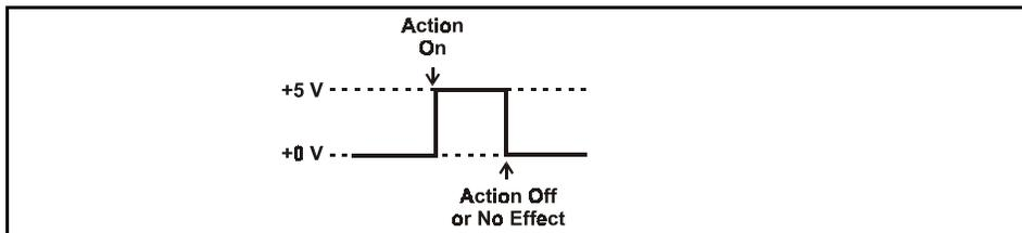
*Figure 12-1. Positive Edge TTL Input Signal Mode*
